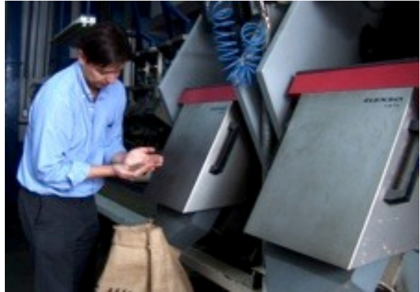
Siebte Selektion: Optische Prüfung mit dem Laser
